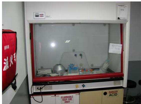
圖五、通風廚中不應放置實驗物品。
